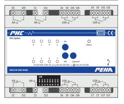
Mit den Verbraucherausgängen (O0-O7) des Ausgangsmoduls können ohmsche und induktive Verbraucher geschaltet werden. Für die Ausgänge wird eine externe Spannung von 230V AC benötigt. Sie ist seperat für jeden Ausgang an eine der Anschlussklemmen (I0-I7) anzuschließen.
