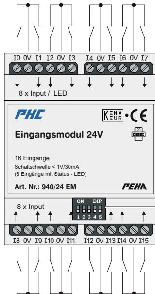
Für jeweils 2 Tasteingänge ist ein 0V Anschluss (Masse) vorgesehen. Die 0V Anschlüsse sind intern im Modul verbunden. Es ist darauf zu achten, dass die Taster mit der Masse des Moduls betrieben werden, an der sie angeschlossen sind.
