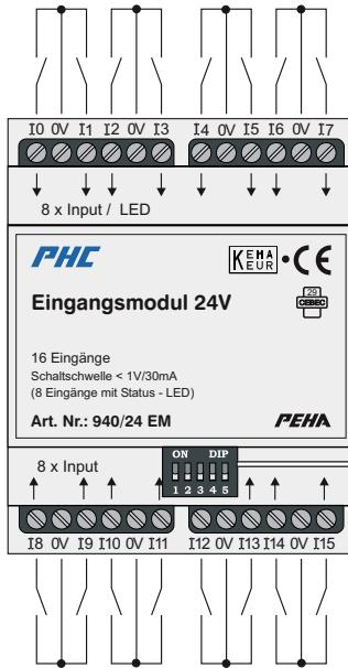
Voor elke 2 pulsdrukkeringangen is een 0 V aansluiting (massa) beschikbaar. De 0 V aansluitingen zijn intern in de module verbonden. Let erop dat de pulsdrukkers worden gebruikt in combinatie met de massa van de module waarop ze aangesloten zijn.
